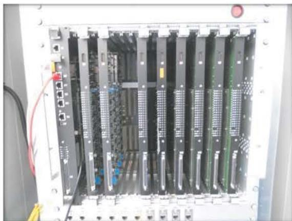
*Аппаратная стойка с блоком плат, обеспечивающих управление многолучевой ГАС ELAC SeaBeam (обведена красным) предыдущего поколения (слева) и сборка нового излучателя (справа) с платой Tx-контроллера (слева) и восемью излучающими платами*
