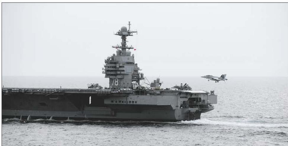
*Истребитель F/A-18F «Супер Хорнет» эскадрильи воздушных испытаний и оценки совершает посадку на палубу авианосца «Джеральд Форд» в ходе проверочных испытаний в Атлантическом океане*
