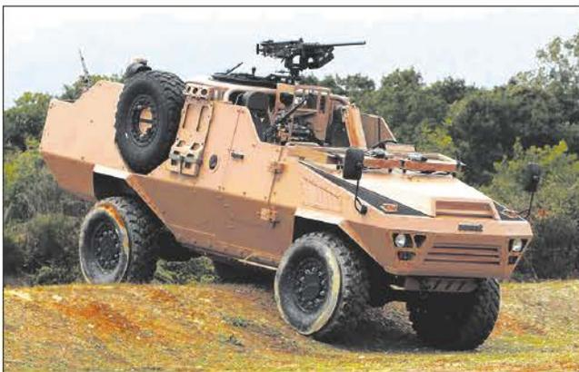
***БТР «Бастсион» французского производства может быть оснащен 7,62- и 12,7-мм пулеметами, либо 40-мм автоматическим гранатометом или ПТРК***
