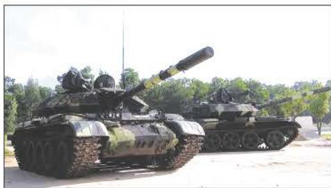
управления огнем TIFCS-3BU, обеспечивающей автоматическое наведение пушки, и ведение прицельного огня во время движения. Танк получил также реактивную и композитную броню, модифицированную 100-мм пушку.
