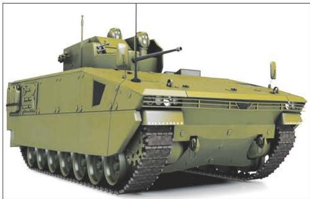
*Общий вид гусеничной БМ «Тулпар» в варианте БМП с 30-мм автоматической пушкой*
