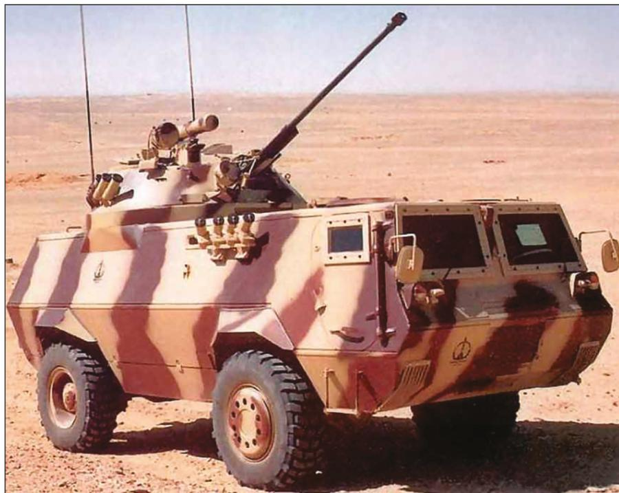
ные пусковые установки (ПУ) дымовых гранат. Конструкция ББМ позволяет устанавливать различное вооружение: одноместные вращающиеся башни с одним или двумя пулеметами калибра 7,62 мм, 20-мм автоматической пушкой; пусковые установки неуправляемых ракет. Имеется также вариант машины с 30-мм автоматической пушкой от БМП-2 российского производства и одной ПУ ПТУР. Боевая масса ББМ 10,9 т. Экипаж два человека. В зависимости от комплектации в десантном отделении могут разместиться до десяти пехотинцев.
