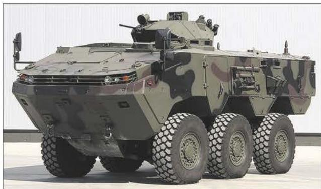
*Боевая бронированная машина «Арма» с колесной формулой 6 x 6 (вверху) и 8 x 8 (внизу). В состав вооружения БМ (8 x 8) включены ПТУР «Лумтас»*
