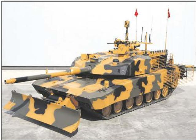
Особенностью нового танка станет его оснащение 120-мм орудием МКЕК-120, аналогичным немецкому Rh-120/L55. Данная пушка способна обеспечить начальную скорость бронебойного подкалиберного снаряда М829А2 около 1 750 м/с (у орудий L44 – 1 660 м/с), что увеличит бронепробиваемость и точность стрельбы.
