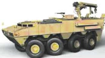
Бронированная ремонтно-эвакуационная машина ARV
