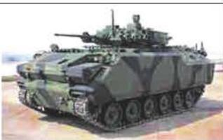
*Варианты смонтированных безэкипажных башен на БМ АСВ*
