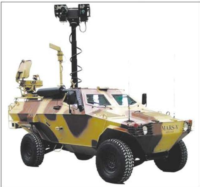
*БМ «Кобра» с разведывательной аппаратурой с РЛС «Серхат» (вверху) и броневедомитель «Кобра-2» с дистанционно управляемым модулем вооружения (внизу)*
