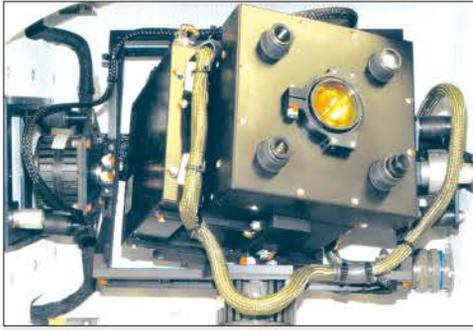
*Опτικο-электронная система БПЛА «Луна» (вверху) и РЛС с синтезированной апертурой антенны MiSAR (справа)*
