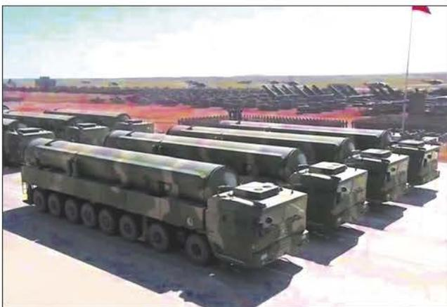
*На вооружение ракетных войск поступают модифицированные межконтинентальные баллистические ракеты (МБР) «Дунфэн-31АГ», оснащенные разделяющейся головной частью*
